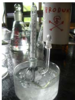
rys. 4. Piknometr napełniony cieczą i przygotowany do ważenia (schłodzony w łaźni lodowej do odpowiedniej temperatury, objętość cieczy wyregulowana do określonej wartości).
