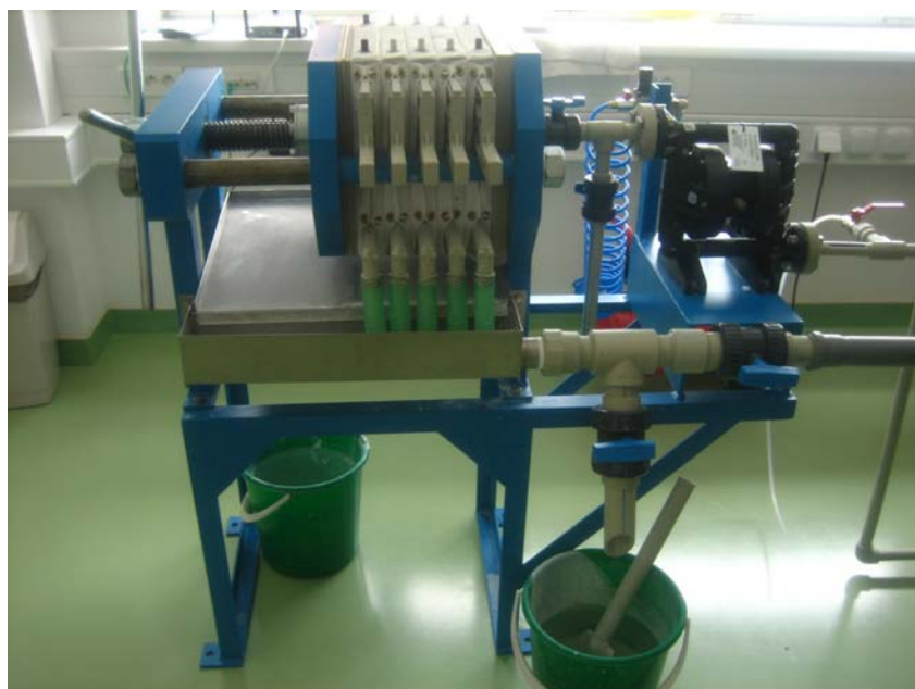
fot.1. Model prasy filtracyjnej (Technical University of Ostrava, Czechy).
