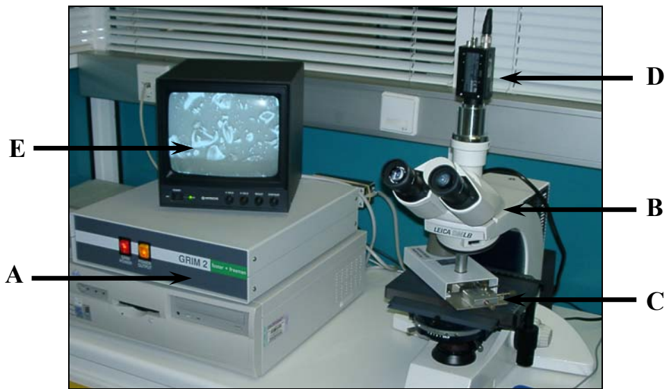
Fot. 3. Zestaw GRIM - analizator GRIM (A), mikroskop (B), stolik grzewczy (C), kamera TV (D) oraz monitor (E).
