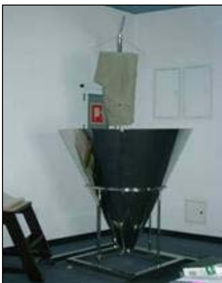
Fot. 2. Lej stosowany w Instytucie Ekspertyz Sądowych w Krakowie w procesie odzyskiwania okruchów szkła metodą szrotkowania (fot. Jerzy Szot).
